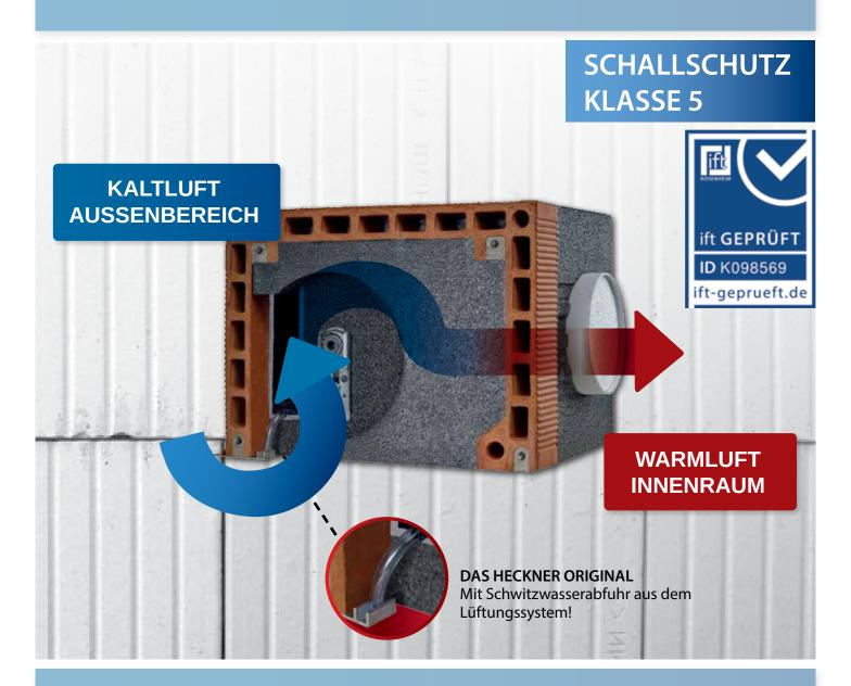
AIR ISO COMFORT ist eine weitere Systemlösung zur optimalen Be- und Entlüftung ihres Hauses, der Luftaustausch findet hierbei im Behangraum statt, somit wird keine Außenblende mehr benötigt. Durch das Ansaugen der vorgewärmten Luft des Roll- bzw. Behangraumes erzielen wir eine erhöhte Effizienz der Wärmerückgewinnung. Der dreifache Schallumbruch bietet erhöhten Schallschutz und verringert Lärm im Innenbereich auf das Minimum.
