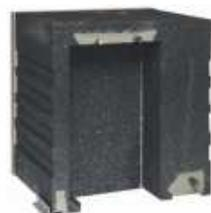
Raffstorekasten mit 12 cm Revisionsöffnung, die Schachthöhe von 22cm kann eine gesamte Verschattungshöhe von 230 cm in sich aufnehmen (60 mm Flachlamelle).
