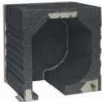
Rollladenkasten für 37 mm Stabhöhen, Behanghöhen von bis zu 350 cm möglich bei Verwendung von 40 SW-Stahlwelle (Rollraum 19 cm Durchmesser).
