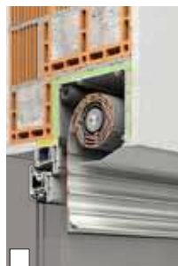
Standardmontage als Linksroller in die Laibung (Abb. XP-System im einschaligen Mauerwerk mit Sonderausstattung Insektenschutzgitter)
